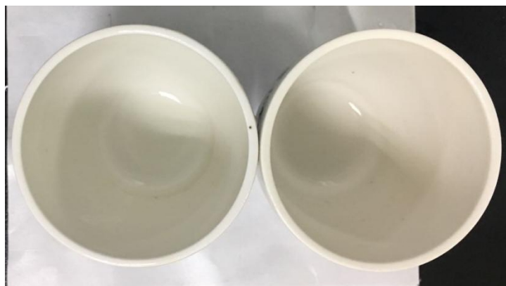
图 3：降低灼烧温度富氧条件下灼烧酸溶后坩埚底部图
